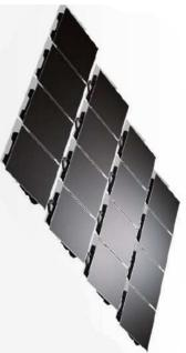
pannelli fotovoltaici in silicio amorfo, costellati ciascuno da 125 celle connesse in serie, corrente inversa massima 4 A, tensione massima di sistema 1000 V, potenza elettrica massima 120 Wp, dimensioni mm 1500x500x40 (h)
