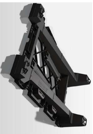
struttura inclinata fissa, di supporto dei pannelli, per garantire l'inclinazione di progetto indipendentemente dall'orientazione della copertura. Questo tipo di installazione permette inoltre di preservare una camera d'aria di 20mm per l'isolamento acustico.
