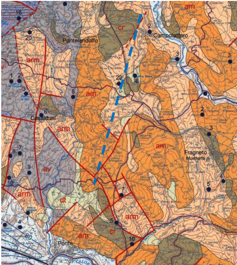
Figura 53 Stralcio della Carta idrogeologica della Provincia di Benevento (Esposito et al. 2005) In cui sono segnalati 6 punti d'acqua con portate inferiori a 1 l/s nell'area d'interesse del tracciato della Galleria (tratteggio in blu)
