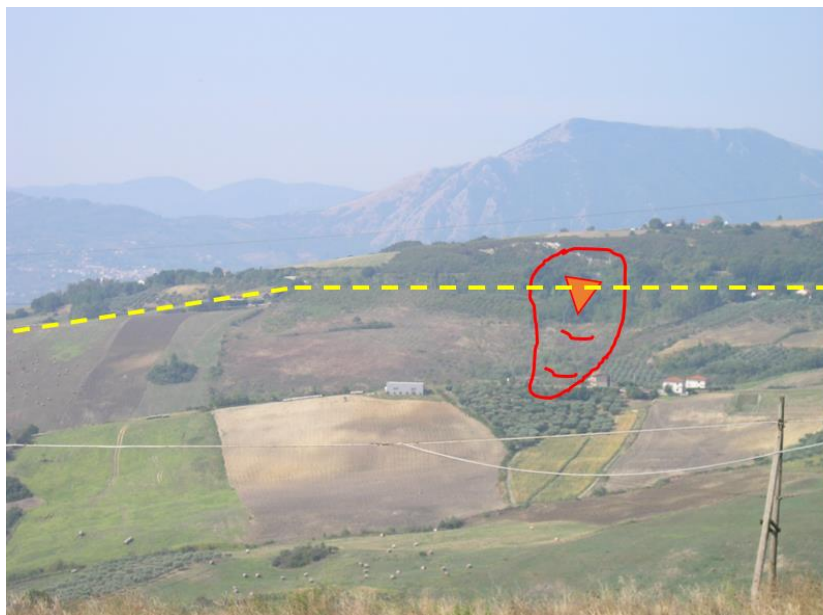
Fig.28 La livelletta della condotta corre, a circa 30-40 m al di sotto della strada provinciale interrotta per frana.
