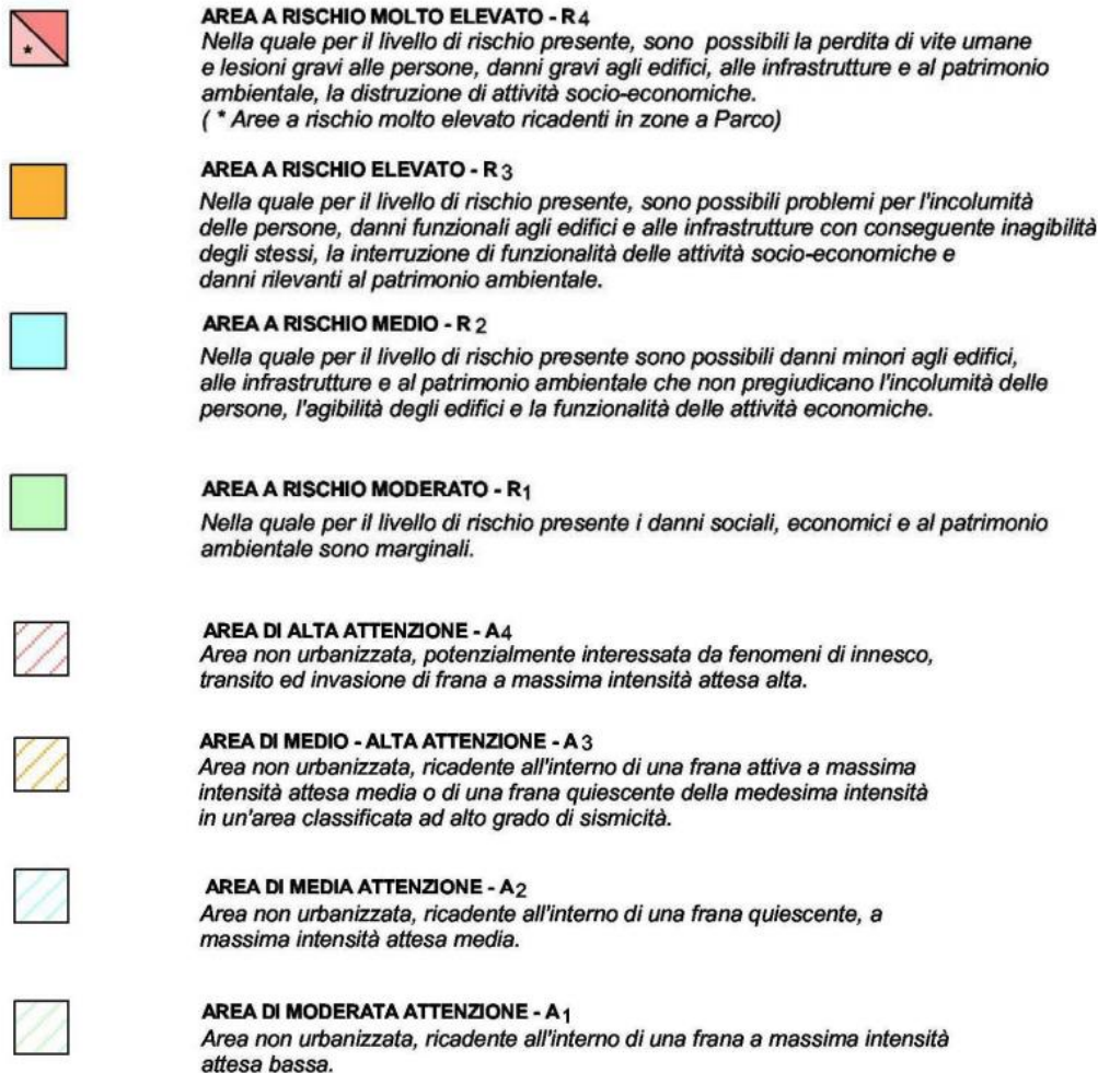
Figura 12 Legenda del rischio del PAI dell'Autorità di Bacino dei fiumi Liri, Garigliano e Volturno.
