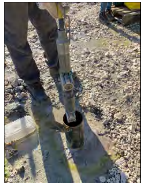
Fig. 3 – Componente ricettiva degli impulsi sismici della strumentazione.
