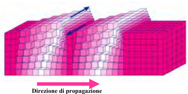
Fig.3 - Rappresentazione grafica delle direzioni di oscillazione delle particelle che costituiscono il mezzo nel caso della propagazione di onde di taglio S (direzione di oscillazione perpendicolare alla direzione di propagazione dell'onda).
