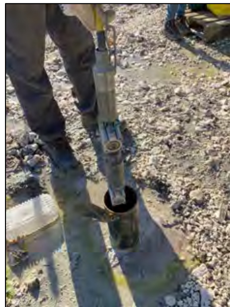
Fig. 3 – Componente ricettiva degli impulsi sismici della strumentazione.
