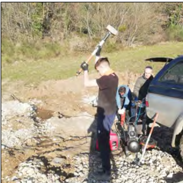
Fig. 4 – Energizzazione in onde P (a sinistra) e in onde S (a destra).
