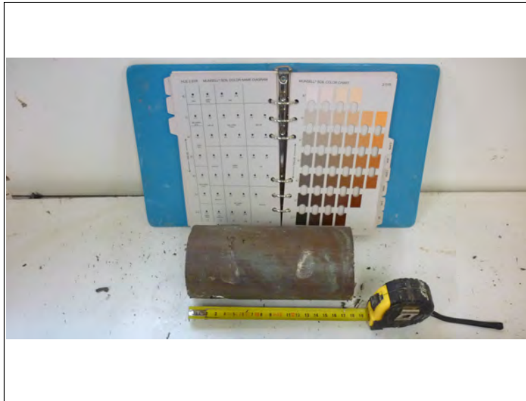
Argilla con limo con struttura scagliosa, di colore grigio con striature violacee.
