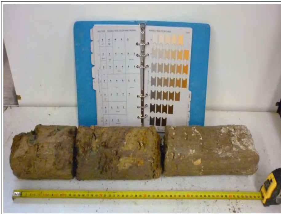
Argilla con limo sabbiosa di colore marrone con striature di colore marrone scuro-nerastro. Presenza di inclusi millimetrici calcarei
