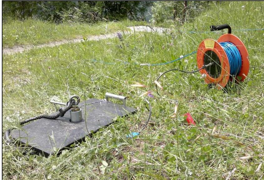
*Fig. 3.2 – Esplositore sismico (P-Wave) e sistema con geofono trigger*
