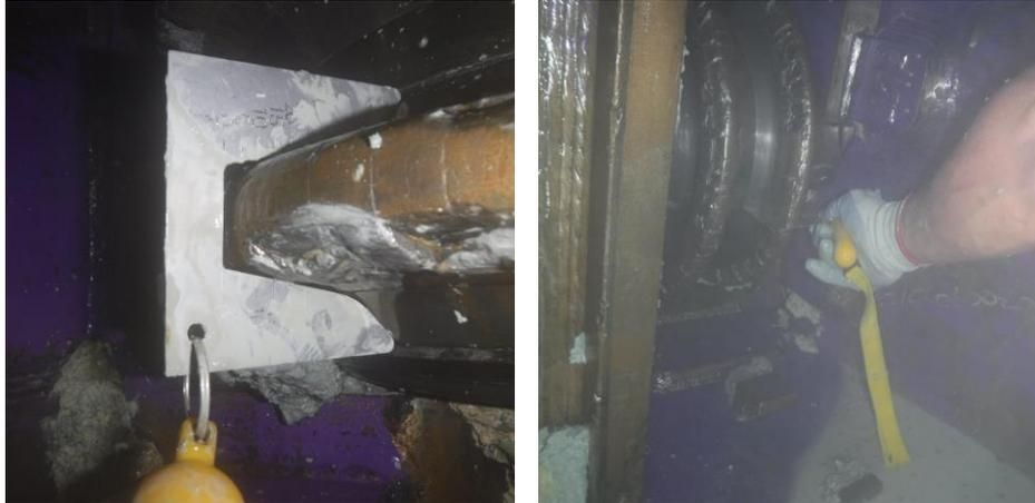
**Fig. 4.2 – Misura dell'usura dei cutters durante l'operazione di ispezione e manutenzione nella camera di scavo**
