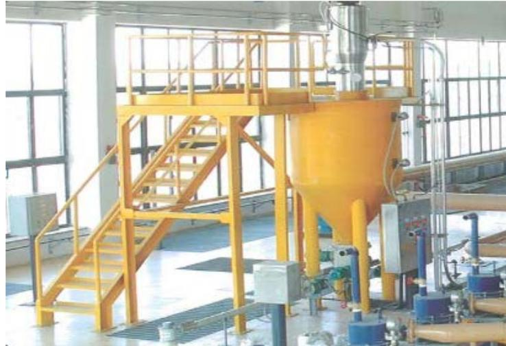
**Stoccaggio zavorra, sistema di trasporto e dosaggio con coclee**
