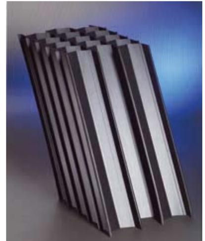
L'acqua fluisce nel comparto di sedimentazione sotto i moduli di pacchi lamellari e scorre poi verso l'alto attraverso i canali di cui sono costituiti questi pacchi. Le particelle e i fiocchi depositati sulle lamelle scivolano verso il basso per gravità. L'uso combinato di un'elevata velocità allo specchio, associata all'inclinazione delle lamelle (60°), consente una continua pulizia, minimizzando così l'accumulo di fiocchi sulle piastre.
