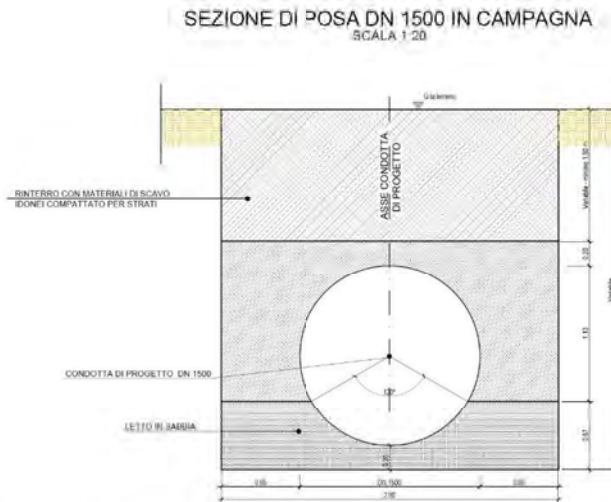
Figura 10: Sezione tipo condotta adduzione ACAM
