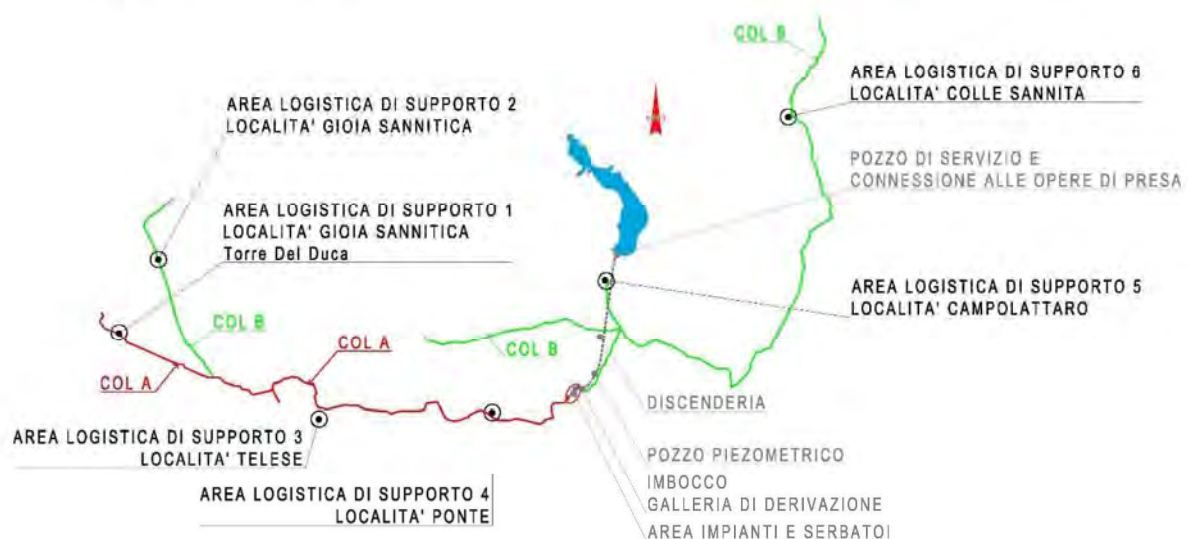
Figura 55: Key plan acquedotto con individuazione Aree Logistiche di Supporto e individuazione dei COL - a e COL - b.
