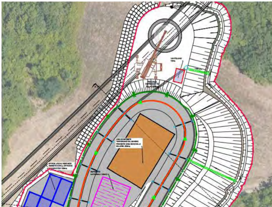
Figura 8.4 – Area di Deposito Temporaneo delle TRS – Area di cantiere Pozzo Piezometrico
