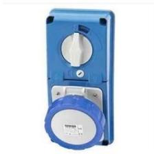
Preso CEE 17 a protezione attiva, con interruttore di blocco per installazione da quadro 16A 2P+T 230V IP44, in tecnopolimero termoplastico rinforzato ad alta stabilità.
