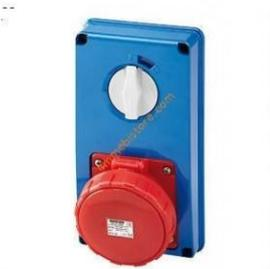
Preso CEE 17 a protezione attiva, con interruttore di blocco per installazione da quadro 16A 3P+N+T 400V IP44, in tecnopolimero termoplastico rinforzato ad alta stabilità.
