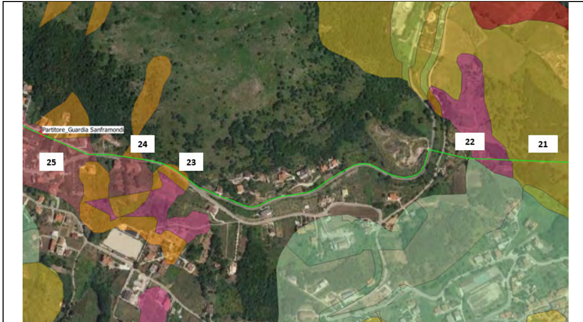
Fig. 2.13 –Estratto cartografico della carta del rischio frana PSAI per l'adduttrice dal partitore di Zingara Morta al partitore di Guardia Sanframondi - dati pubblicati sul sito ufficiale della Regione Campania in formato shapefile
