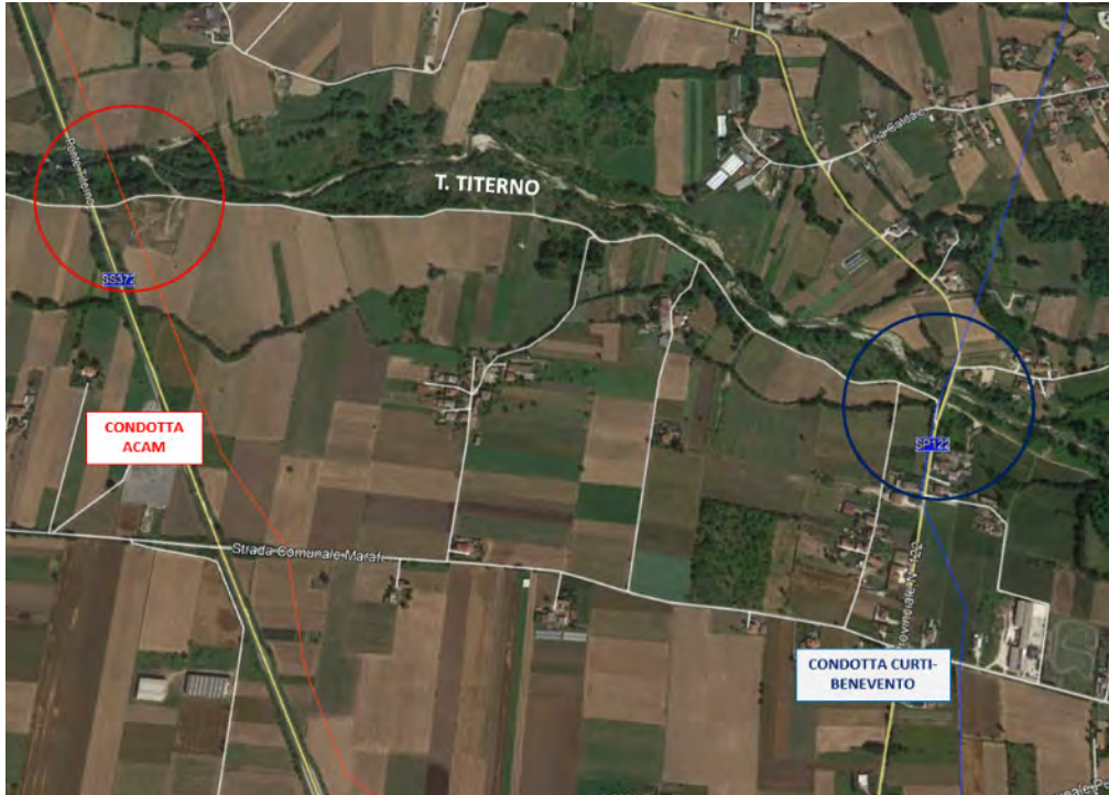
Fig. 2.72-- Attraversamenti del Torrente Titerno su foto aerea
