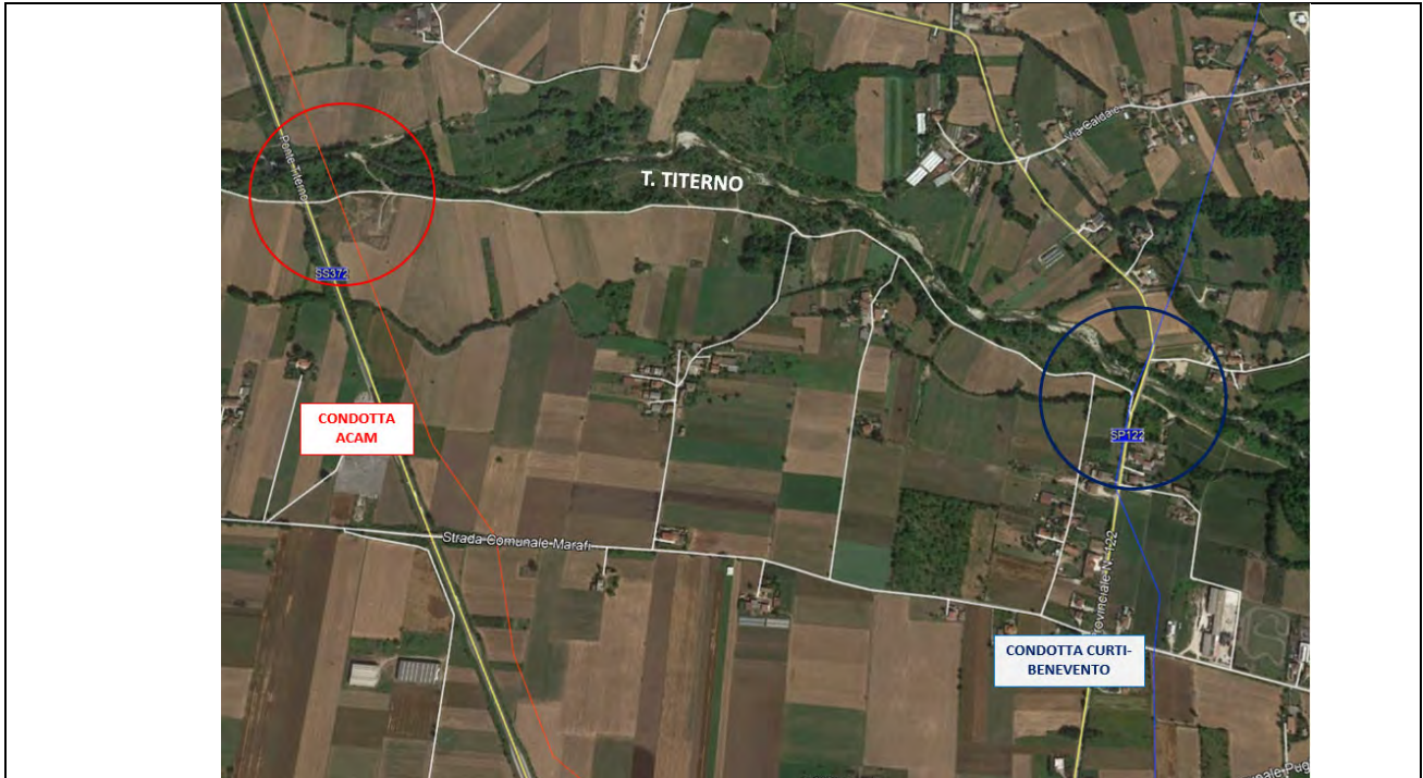
Fig. 2.46 – Attraversamenti del torrente titerno da parte delle due condotte ACAM e Curti-Benevento
