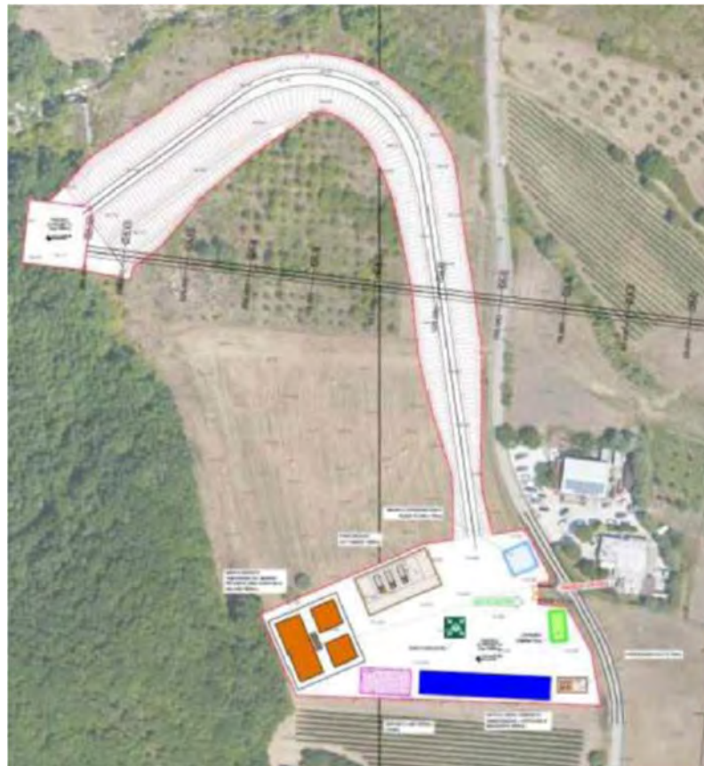
Fig. 2.88- Layout cantiere discenderia accesso laterale
