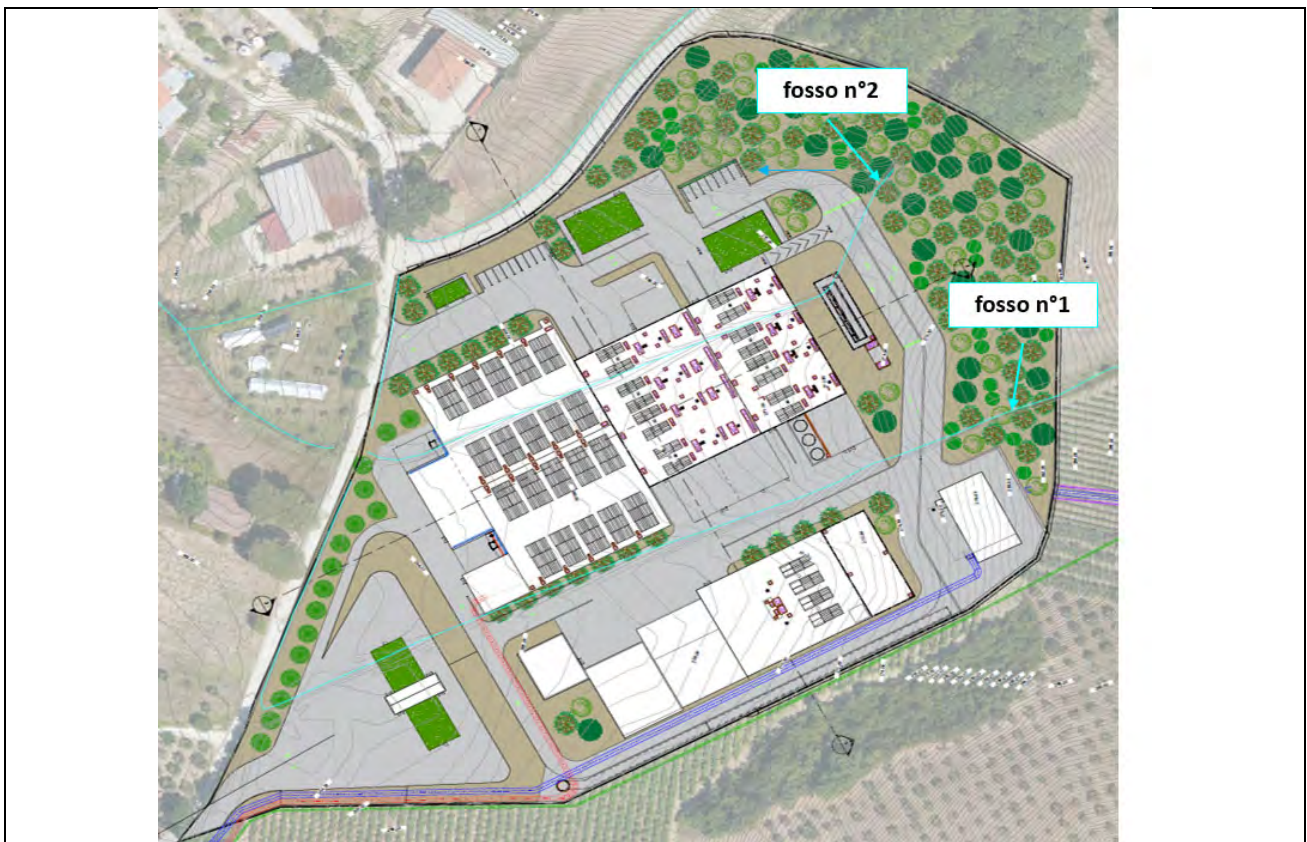
Fig. 2.37 – Mappa delle interferenze tra l'area del potabilizzatore e il reticolo idrografico minore
