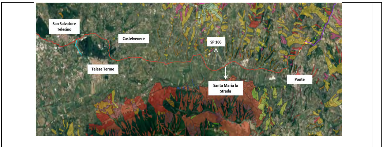
Fig. 2.15 – Estratto cartografico delle aree maggiormente a rischio (carta del rischio frana PSAI) per la fascia parallela alla SP 106- dati pubblicati sul sito ufficiale della Regione Campania in formato shapefile.
