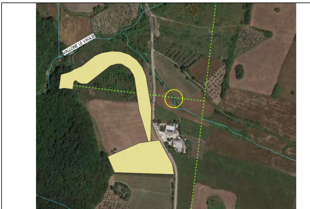
Fig. 2.35 – Mappa delle interferenze tra la discenderia di accesso alla galleria di derivazione e il reticolo idrografico
