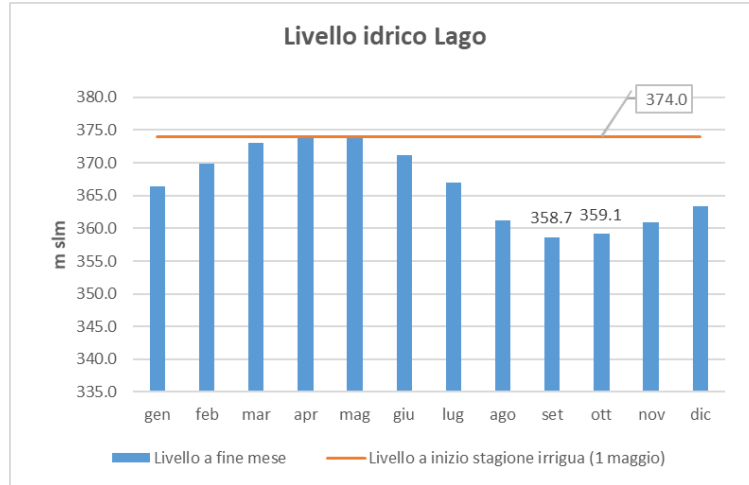
Figura 1-20 Simulazioni di funzionamento: scenario 2.b) clima futuro; scenario di regime. Andamento del volume dell'invaso
