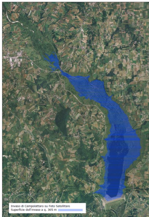
Figura 1-15 Simulazioni di funzionamento: 1.b) clima medio attuale; scenario di regime. Superficie dell'invaso al variare della quota dell'acqua
