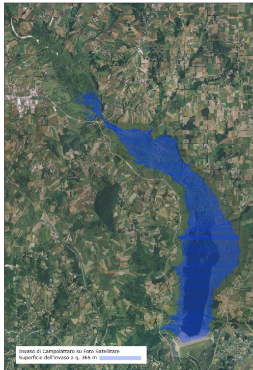
Figura 1-18 Simulazioni di funzionamento: scenario 2.a) clima futuro; scenario transitorio. Superficie dell'invaso al variare della quota dell'acqua
