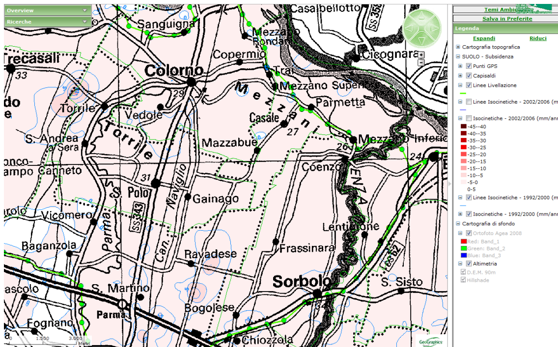
FIGURA 6.2-2. CARTOGRAFIA DELLE VELOCITÀ DI MOVIMENTO VERTICALE DEL SUOLO (PORTALE CARTOGRAFICO DI ARPA EMILIA-ROMAGNA) NELL'AREA INTERESSATA DALLA VIABILITÀ 1PR, SI PUÒ OSSERVARE CHE NEGLI ANNI 1992-2000 I VALORI DI SUBSIDENZA SONO RISULTATI DELL'ORDINE DI 0÷-5 MM/ANNO
