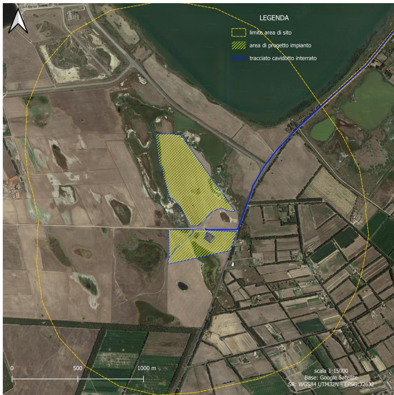
Figura 1.12: Delimitazione area di sito progetto impianto (linea tratteggiata) su foto satellitare (scala 1:15000 - Google Satellite)
