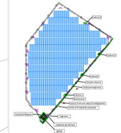
Progetto impianto fotovoltaico "Spinamara Sottana"
