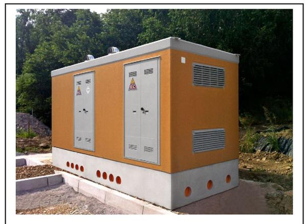
Il sistema Smart Transformer Station è un contenitore compatto di circa 6 m che contiene un trasformatore esterno in olio isolante, il quadri di distribuzione MT ed il pannello LV. Consente una connessione rapida e affidabile dell'inverter PV alle reti MV.
