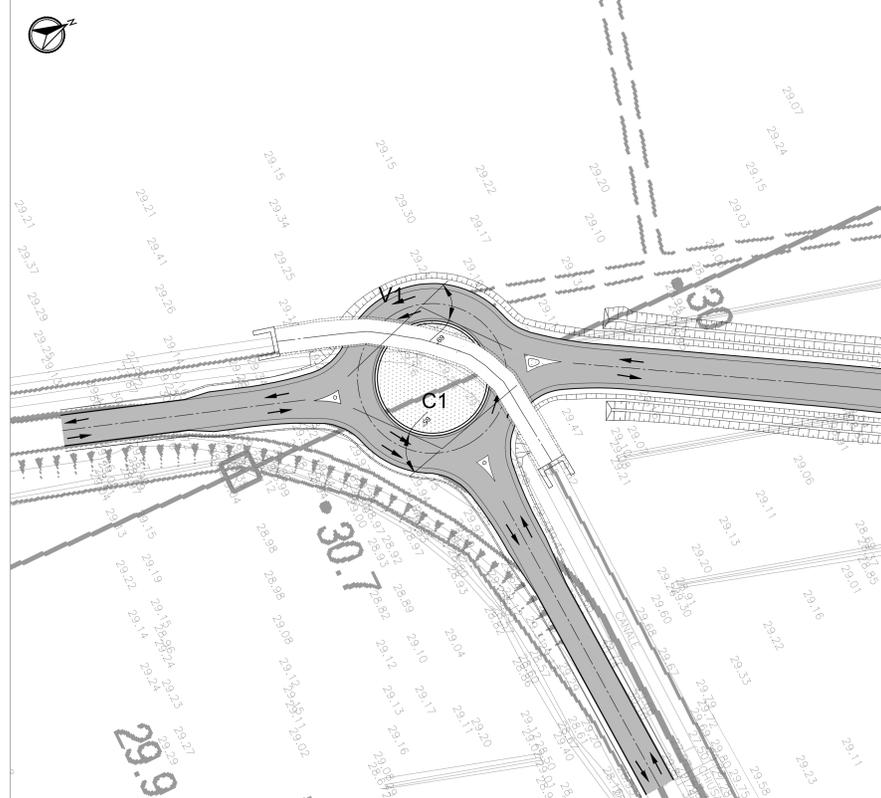
TRIANGOLI DI VISIBILITA' - Scala: 1:500 - ROTATORIA M
