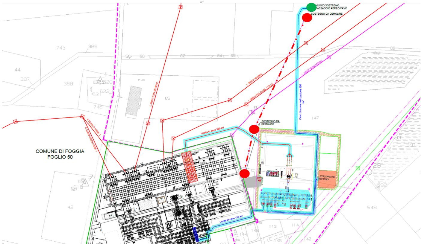
**Fig. 4. Stralcio planimetrico SE-RTN di Foggia con indicazione dello spazio disponibile per la realizzazione del nuovo stallo ingresso cavo 380 kV (riquadro in Rosso) e dello stallo della sezione 150kV (riquadro in blu) per l'attestamento dei cavi 380 kV e 150 kV per l'interconnessione tra l'esistente SE-RTN e la sezione Satellite di Ampliamento. In rosso tratteggiato, il tratto di linea aerea da smantellare con relativi tralicci.**
