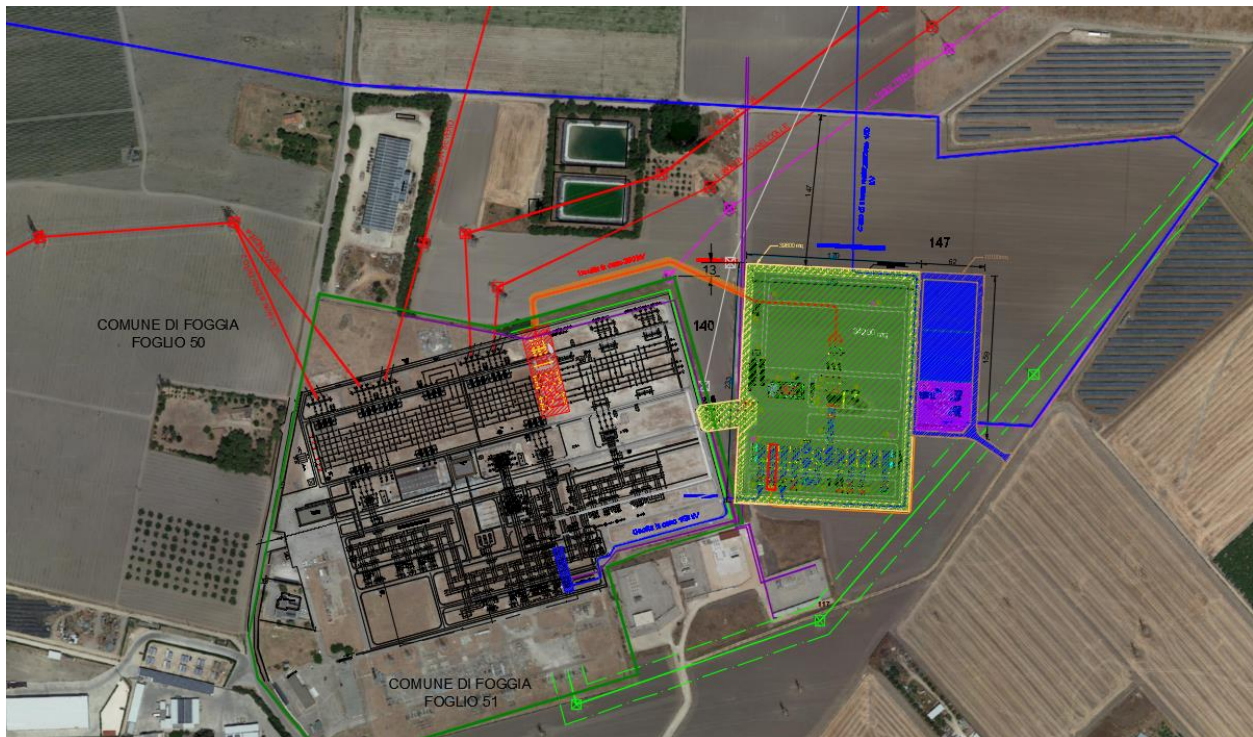
Fig. 2. Foto aerea della SE-RTN di Foggia Sprecacenere con indicazione dell'area per la SE di ampliamento (area colore verde) e area potenziale per allocazione delle Sottostazioni produttori (area colore blu, con in magenta l'area destinata alla SSE della Proponente Hergo Solare Italia)
