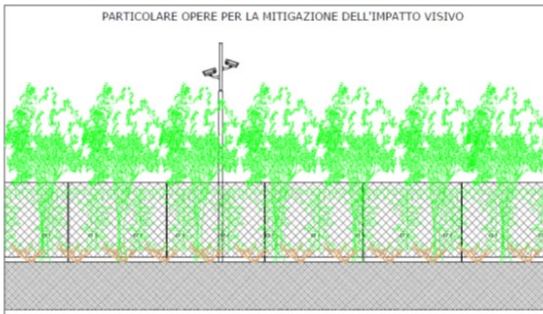
Figura 18 – Opere di mitigazione della recinzione
