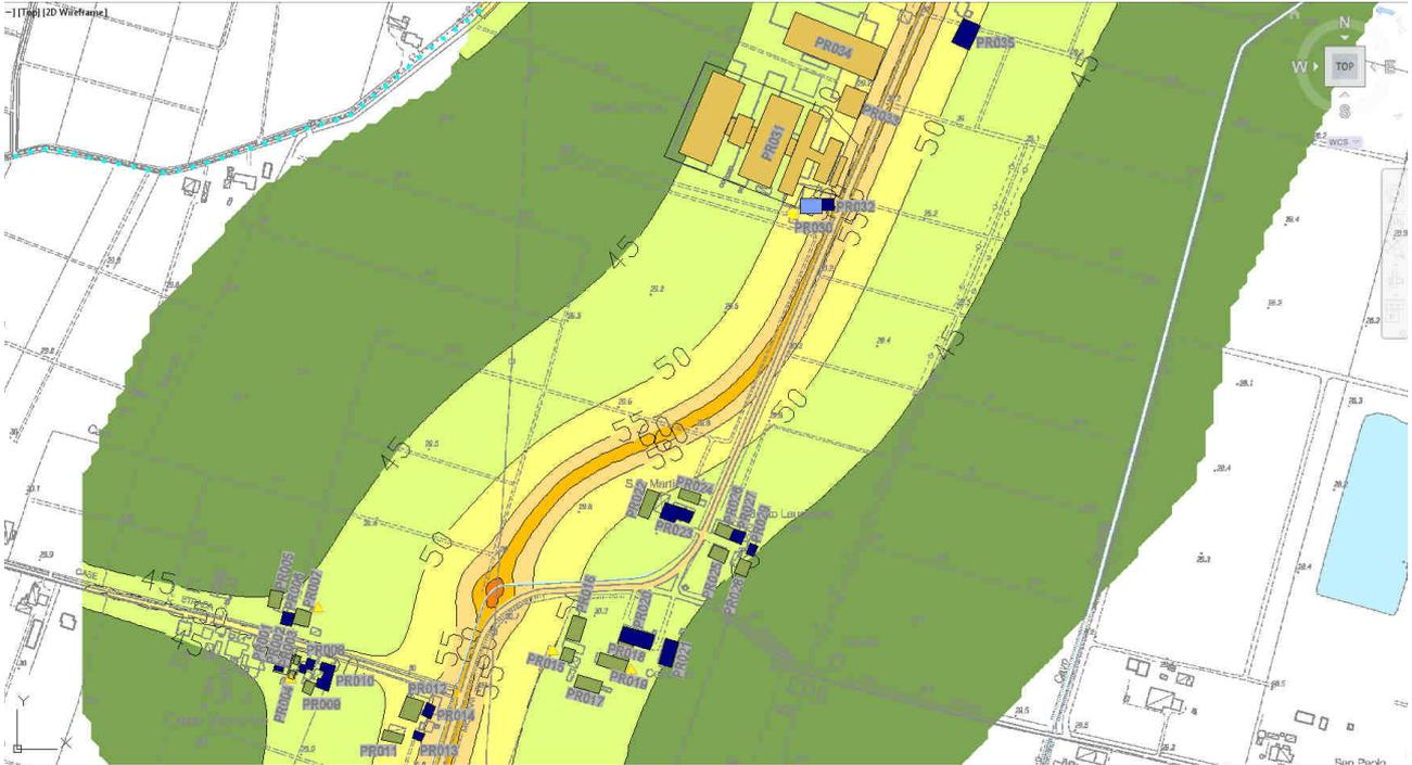
**FIGURA 8.3-1 – DETTAGLIO DELLA MAPPATURA DELLE ISOFONICHE IN CORRISPONDENZA DEL RICETTORE PR032**
