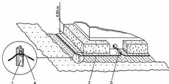
L'impianto di messa a terra sarà costituito da una parte interna di collegamento fra le diverse installazioni elettromeccaniche e da una parte esterna costituita da elementi disperdenti.
