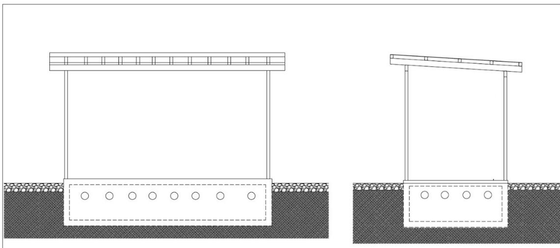
Nella platea di appoggio saranno realizzati i cavidotti necessari ai collegamenti dei componenti dell'impianto. In figura viene rappresentato il box contenente il trasformatore e gli interruttori di sezionamento e protezione della cabina.
