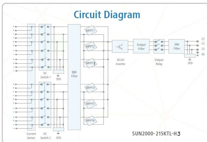
La configurazione dell'inverter permette di collegare ciascuna stringa ad un ingresso indipendente, i quali sono dotati di sezionatori "DC Switch Box" e di SPD, scaricatori di sovratensione, oltre che di un filtro di protezione da armoniche, già integrati nell'inverter.
