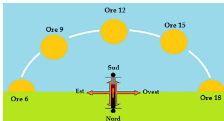
2. Ciascun tracker sarà costituito da n. 60 moduli fotovoltaici, disposti su due file, 30 + 30, che ruoteranno lungo l'asse nord-sud, creando un movimento circolare da est a ovest, e poi ritornare in posizione di riposo a fine giornata. Il numero di tracker previsto è di 504, in grado di portare 30240 pannelli fotovoltaici della potenza di 660 Wp, del tipo monocristallino.
