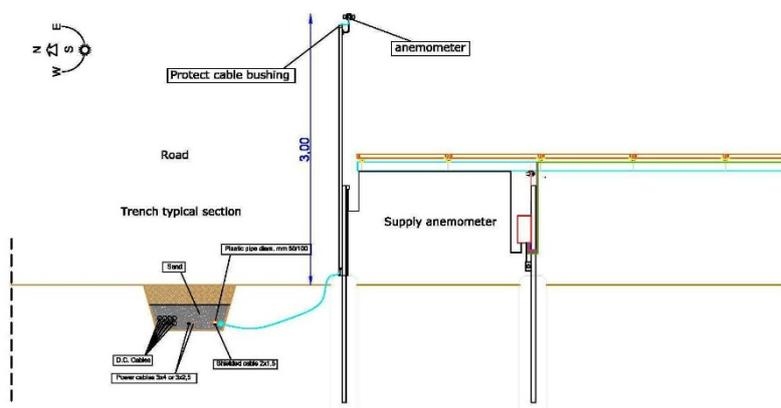
Il tipo di anemometro deve permettere di misurare direttamente la velocità del vento e dell'aria. Dovrà trasferire tali informazioni al sistema di controllo dei tracker per garantire la messa in sicurezza in caso di elevata ventosità o di turbolenze.
