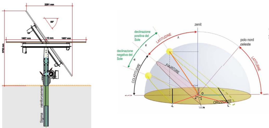
Il sistema di sostegno, visibile nella figura precedente, deve reggere il peso del tracker e dei pannelli, oltre ai carichi derivanti da condizioni ambientali avverse. Su tali pali, su cui saranno montati i sistemi “tracker”, saranno posizionati le strutture di sostegno dei pannelli, realizzati in profilati zincati a caldo ad omega, per il bloccaggio dei moduli fotovoltaici. Ulteriori dettagli sul sistema di fissaggio dei moduli sono riportati nella scheda tecnica fornita dal costruttore.
