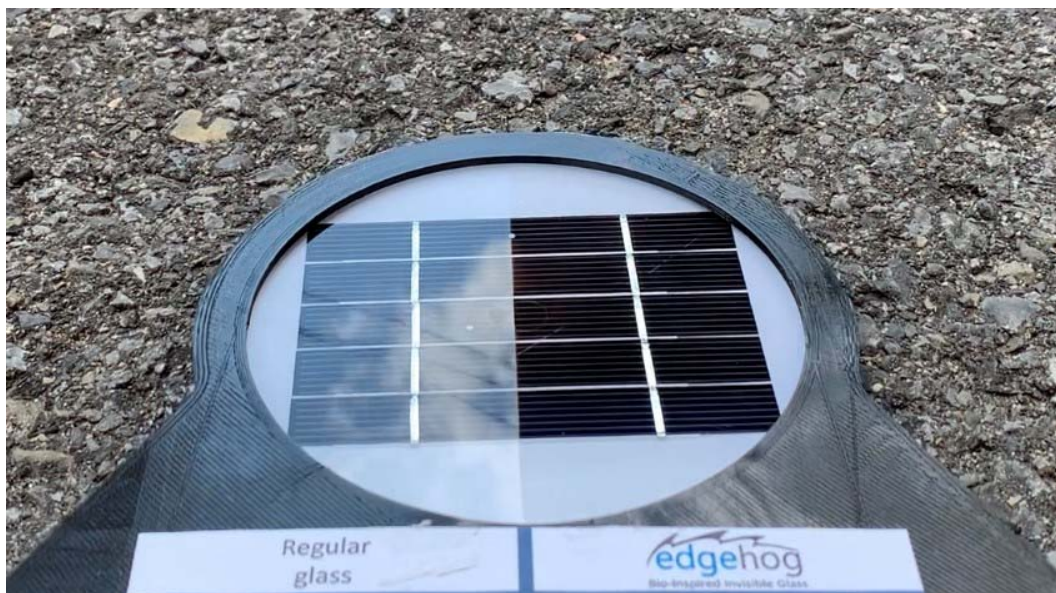
Figura 4: Le due immagini dimostrano in modo lampante come, al contrario di un vetro comune (normal glass), il vetro anti-riflesso (Anti-Reflecting glass) che riveste i moduli fotovoltaici (Photo Voltaic Modules) riduca drasticamente la riflessione dei raggi luminosi
