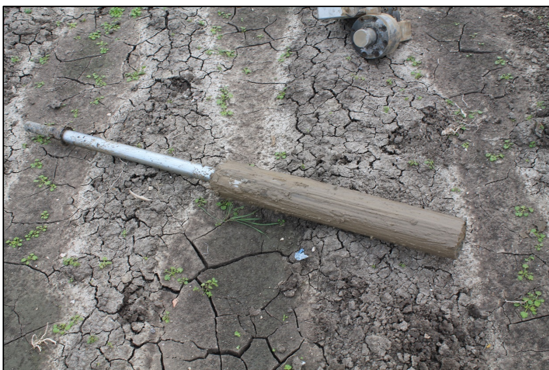
Foto 8 – Prelievo del campione di terreno indisturbato
