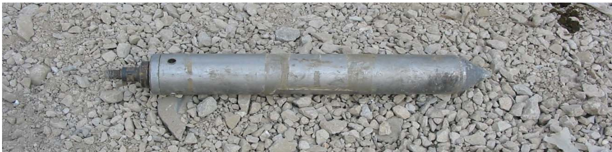
Campionatore nella posizione di infissione a pressione
