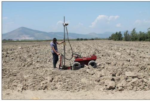
Ubicazione della prova penetrometrica dinamica Pd2
