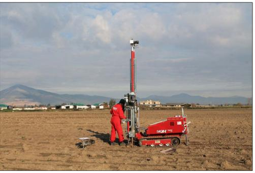
Ubicazione della prova penetrometrica statica CPT2
