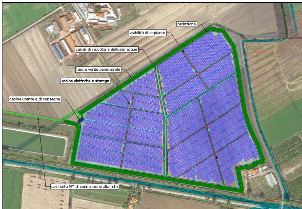
Fig. 5 – Layout dell'impianto agrovoltaico in località Parco del Castello del Comune di Castel Volturno
