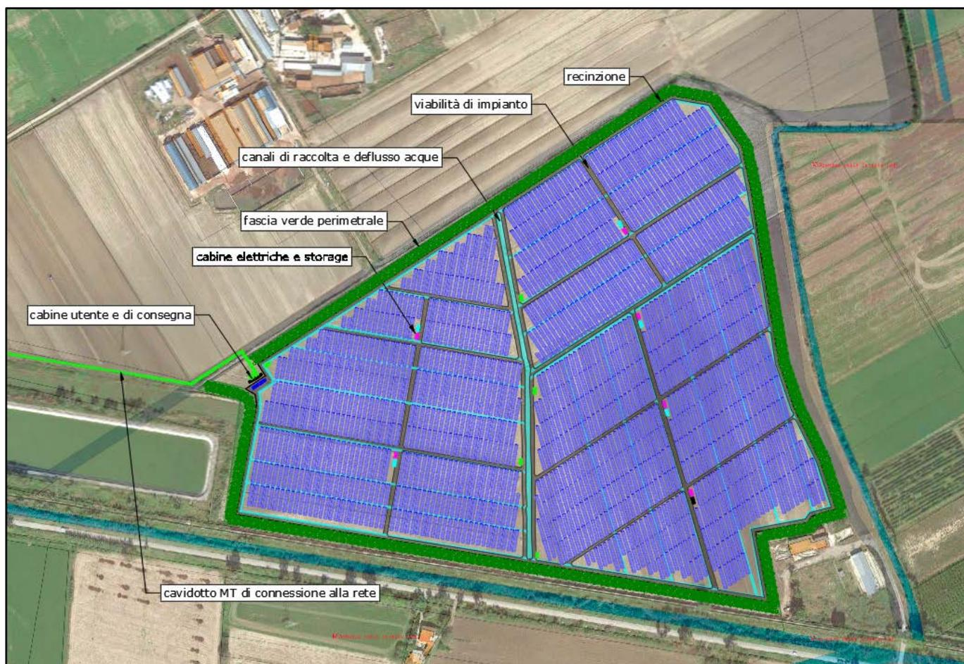
Fig. 7 – Layout dell'impianto agrovoltaico previsto in località Parco del Castello del Comune di Castel Volturno
