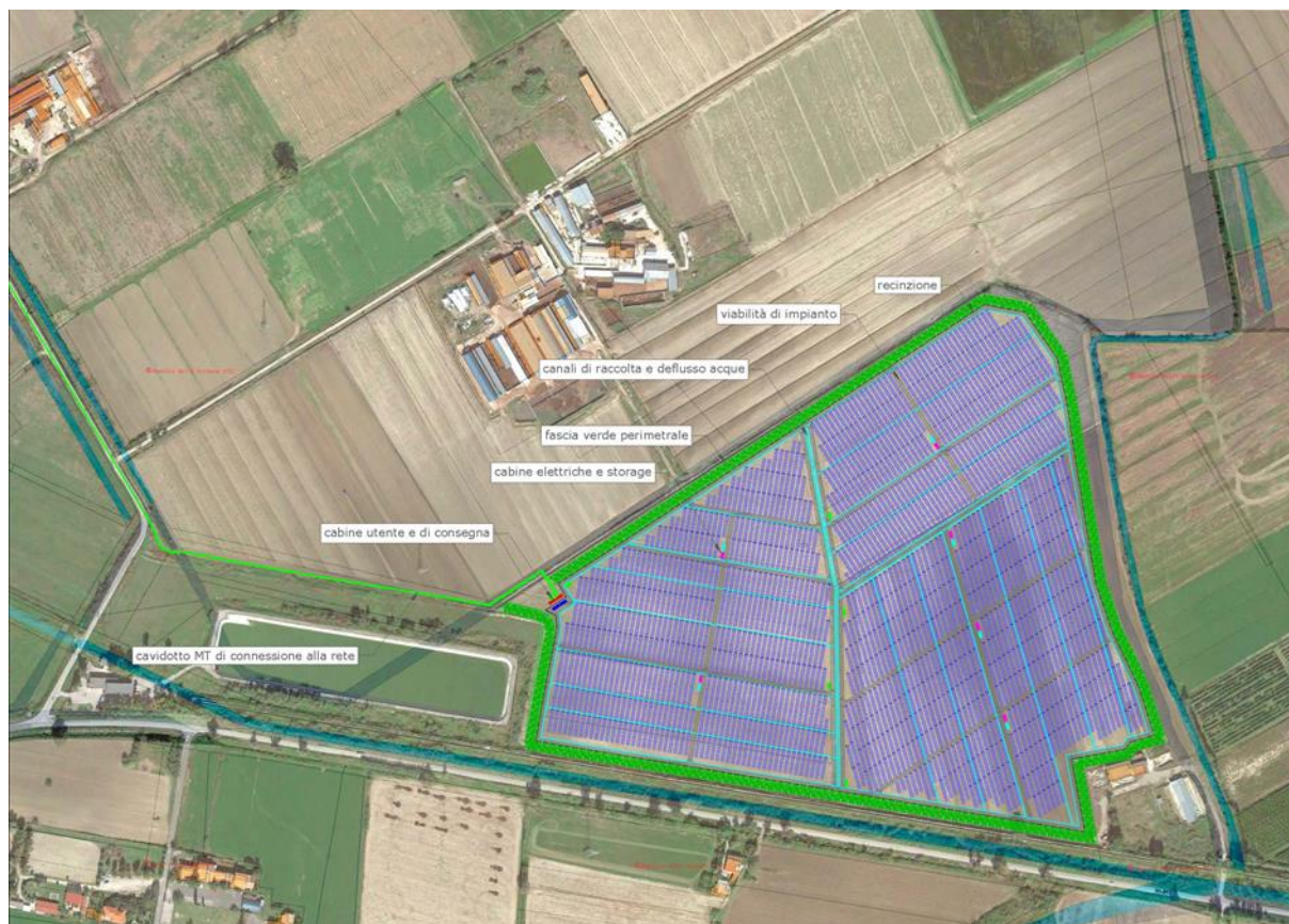
Figura 4 – layout impianto e suo inserimento nel contesto delle colture estensive e sistemi agricoli complessi
