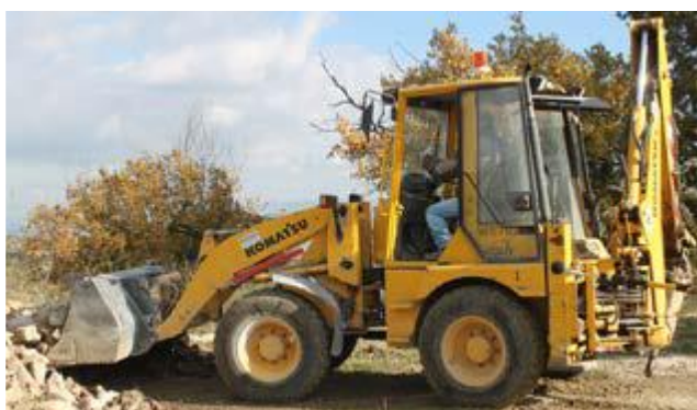
Escavatore caricatore (Terna)
