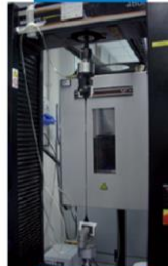
Massima corsa del dinamometro senza osservare la rottura del provino
