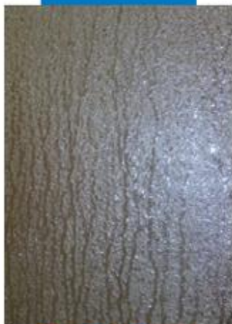
Normale effetto di trasudazione superficiale del prodotto appena applicato
