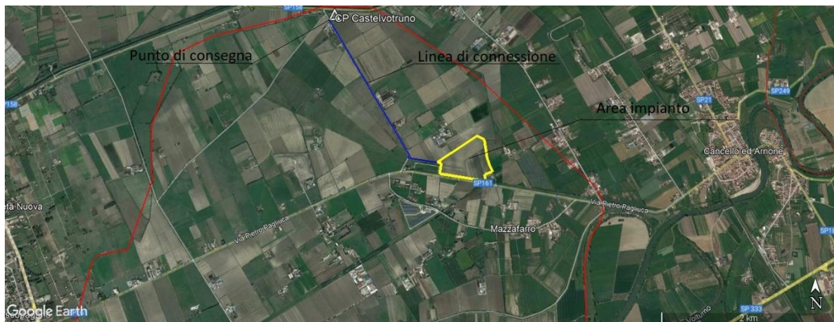
Localizzazione area impianto con tracciato cavidotto e punto di connessione alla rete elettrica - Fonte Google Earth
