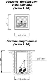
Pozzetto interrato di sezionamento o derivazione in struttura prefabbricata in cemento, con esterno in CLS magro.
