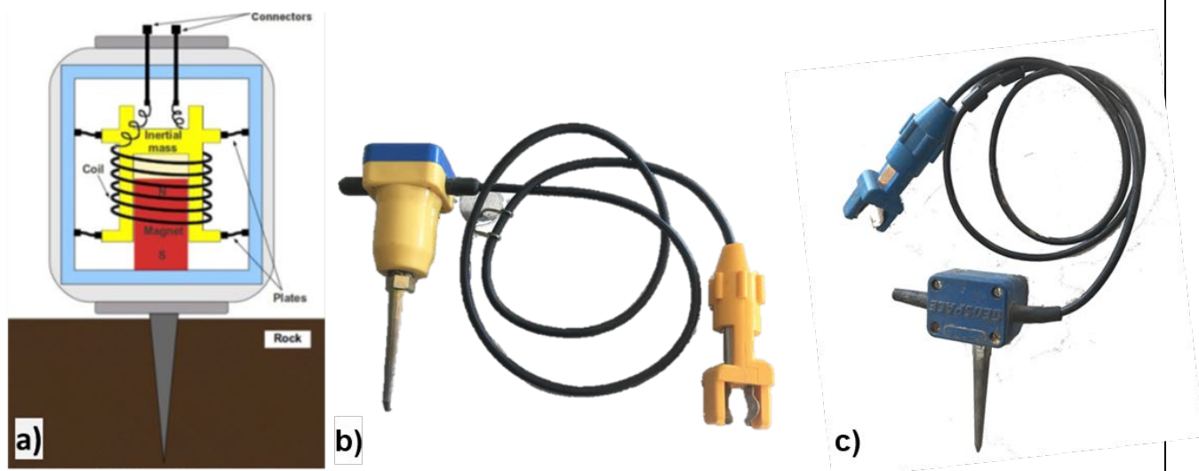
Figura 12 – Geofoni per onda P e Sh; a) schema di funzionamento del geofono per onda P; b) geofono per onda P con frequenza caratteristica di 4.5 Hz; geofono per onda S con frequenza caratteristica di 8 Hz.
