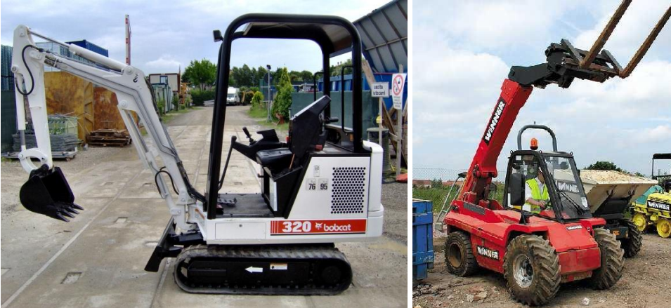
Figura 8 Esempi di macchine operatrici impegnate per la costruzione dell'impianto (Bobcat e Manitou).
