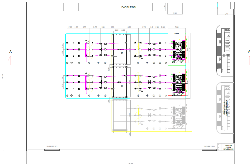
Figura 20: Planimetria tipo SSE Produttore.
