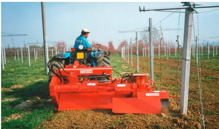
Figura 21: Esempio di fresatrice interceppo per le lavorazioni sulla fila (fonte Cucchi Macchine Agricole).
