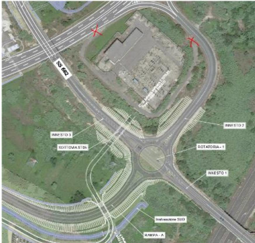
Figura 47 – Sottovia ST05 con evidenza in rosso degli accessi da interdire
