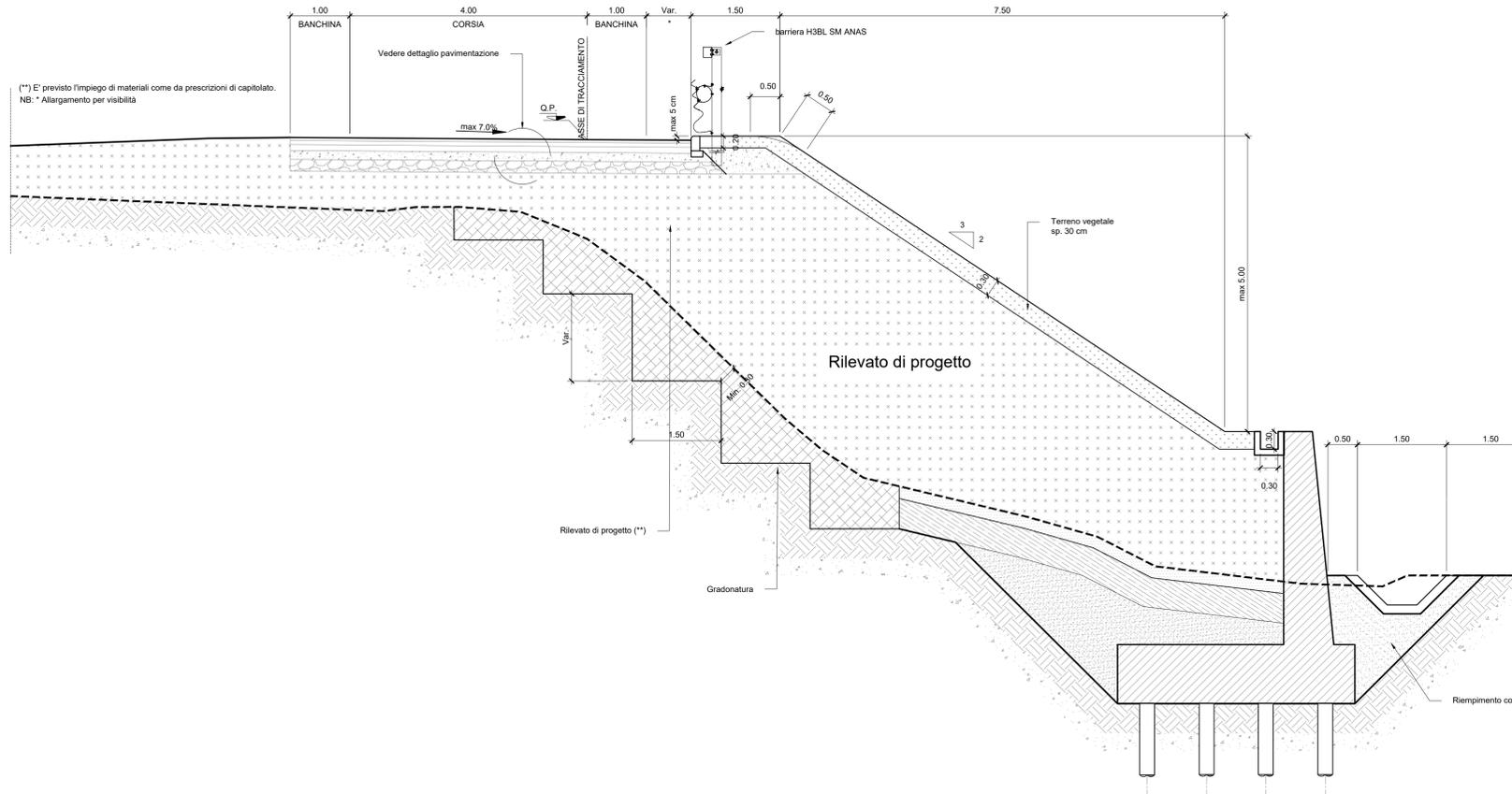
RAMPA MONODIREZIONALE IN RILEVATO CON MURO DI SOSTEGNO - RAMPA C
