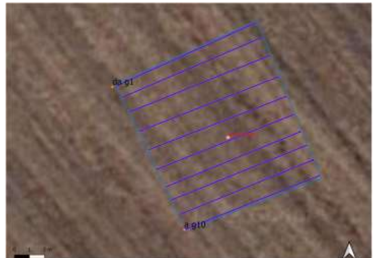
N° 10 di prospezioni georadar di lunghezza circa 10 mt. Prospezione georadar
