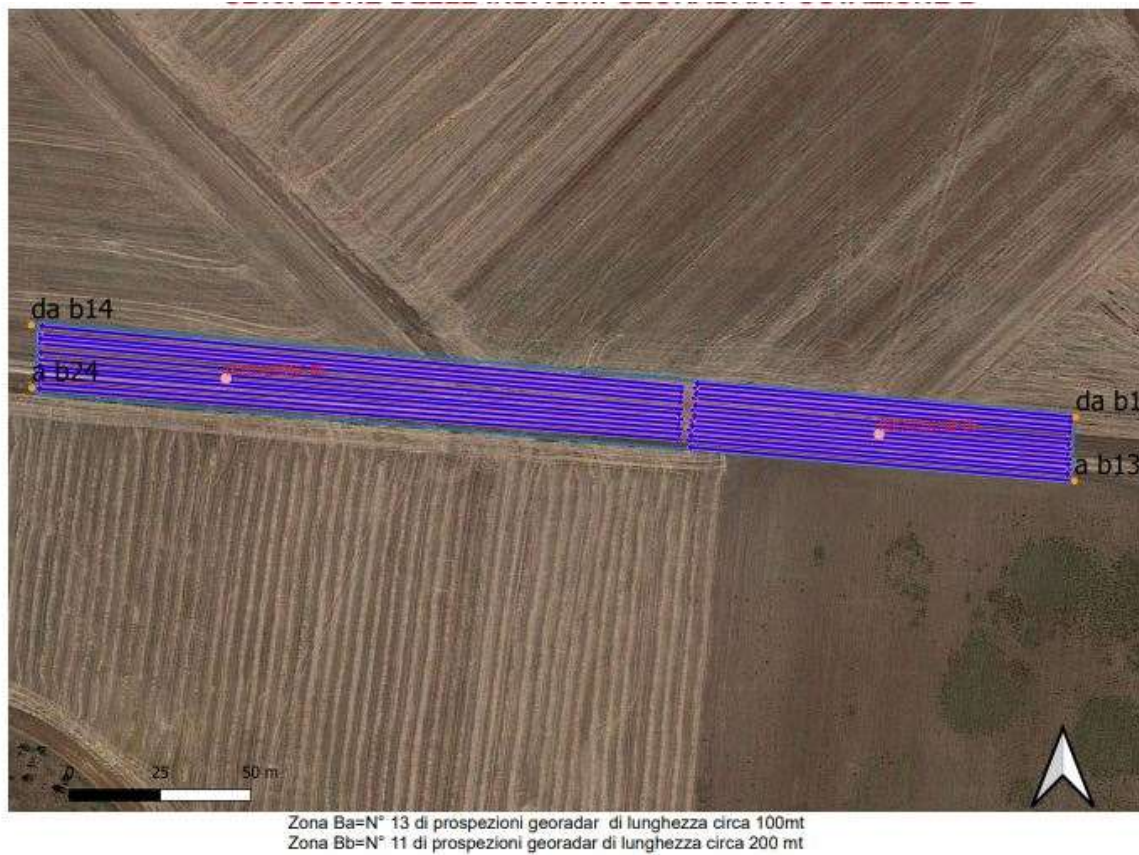
Figura 6: schema delle strisciate effettuate - postazione B
