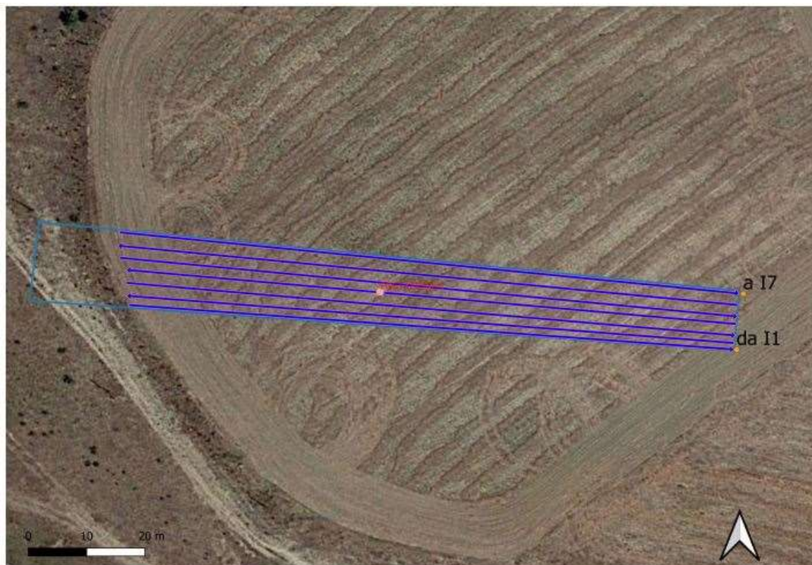
N° 7 di prospezioni georadar di lunghezza circa 100 mt Prospezione georadar
