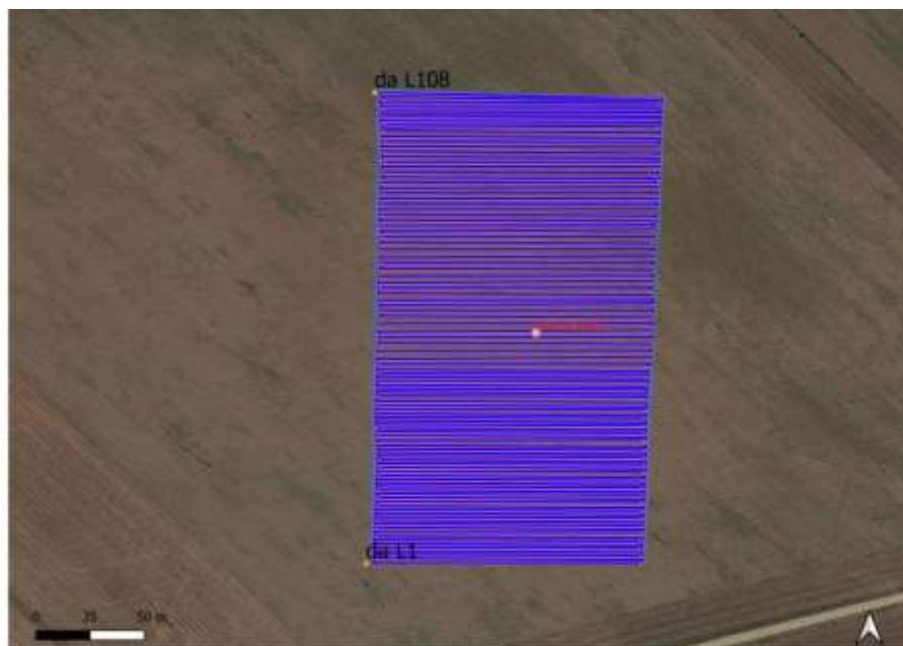
Figura 77: schema delle strisciate effettuate con georadar
