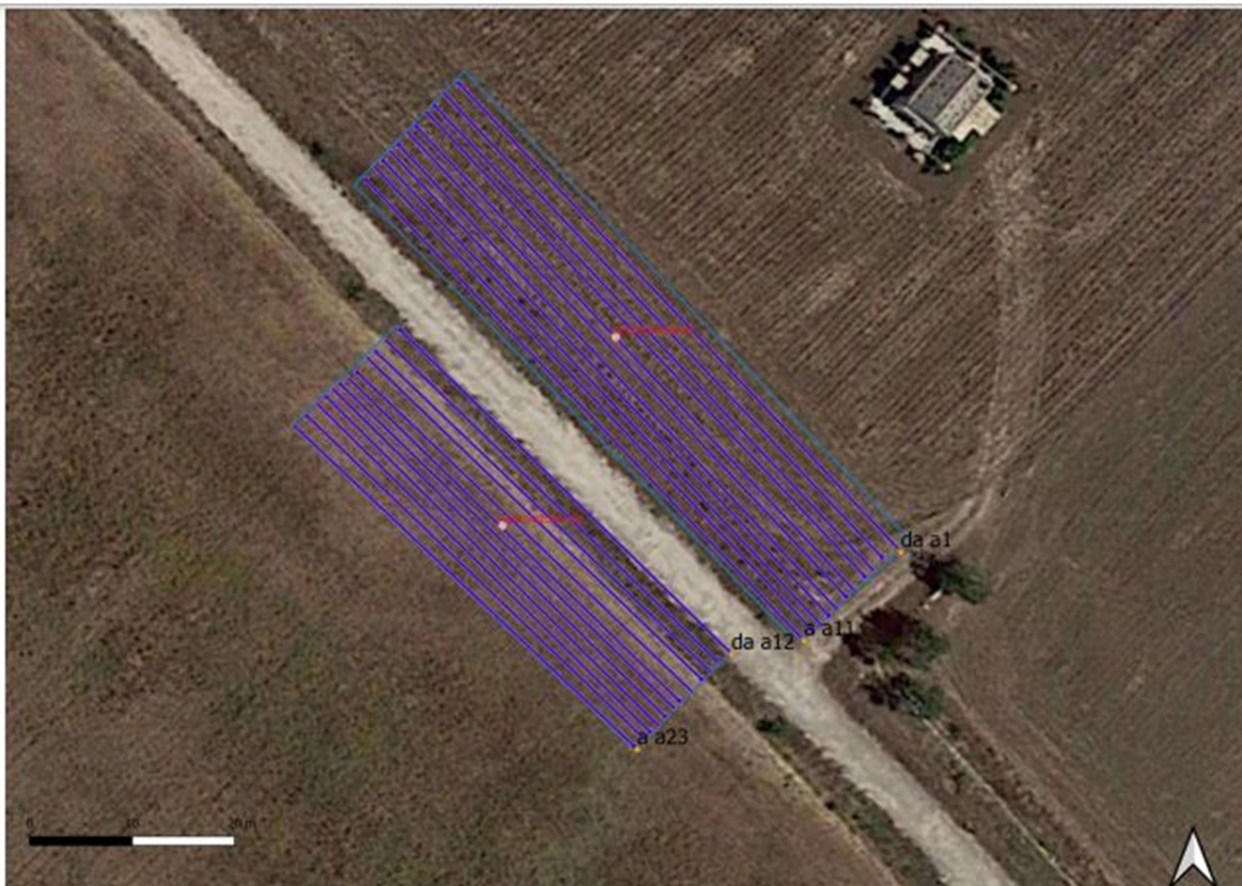
Zona Aa=N° 11 di prospezioni georadar di lunghezza circa 63mt Zona Ab=N° 12 di prospezioni georadar di lunghezza circa 46 mt
