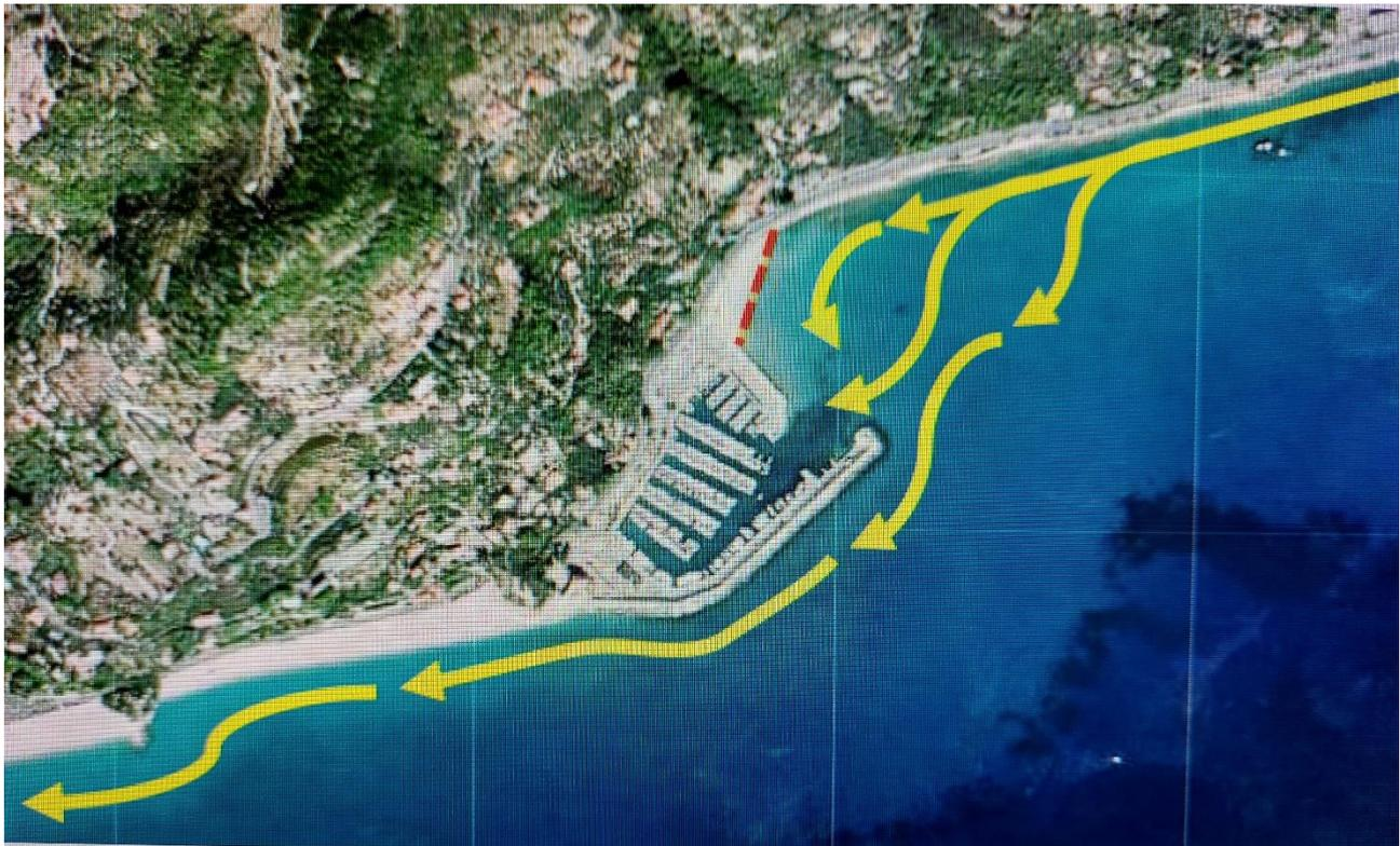
*In rosso il tratto dell'arenile a levante del porto, lungo 142 m, in giallo le correnti dominanti di deposizioni sabbiosa, causa dell'insabbiamento del porto e della formazione dell'arenile stesso. Si nota davanti all'arenile la forte deposizione sabbiosa fino alla testata di sottoflutto (zona chiara) mentre la zona scura all'imboccatura è dovuta al dragaggio portuale.*
