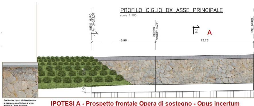
Sono stati comunque studiate differenti soluzioni di rivestimento, con materiale diverso e con differenti trame. Ricorsi verticali o ricorsi orizzontali, un pattern che si ripete su linee parallele e ci dà la possibilità di enfatizzare tutte le opere, rendendoli così parte di una visione totalizzante. Muri e opera infrastrutturale si susseguono ritmicamente dando una visione pulita e fluente
