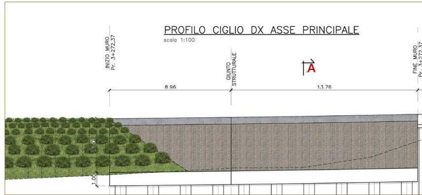
**IIPOTESI C - Prospetto frontale Opera di sostegno - Rigato verticale**
