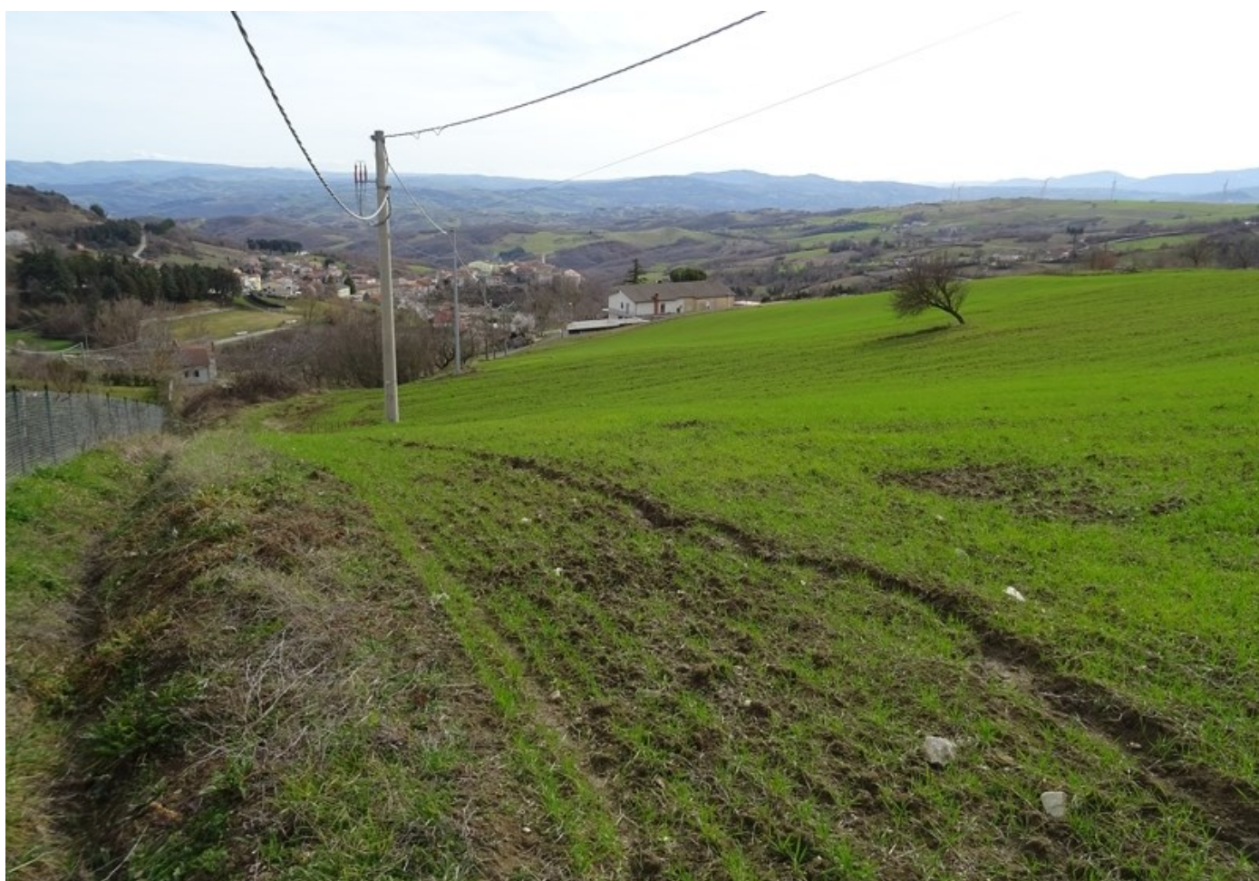
Foto 006 – Corpo della frana Fr_01. Evidenze di movimento sulla vegetazione
