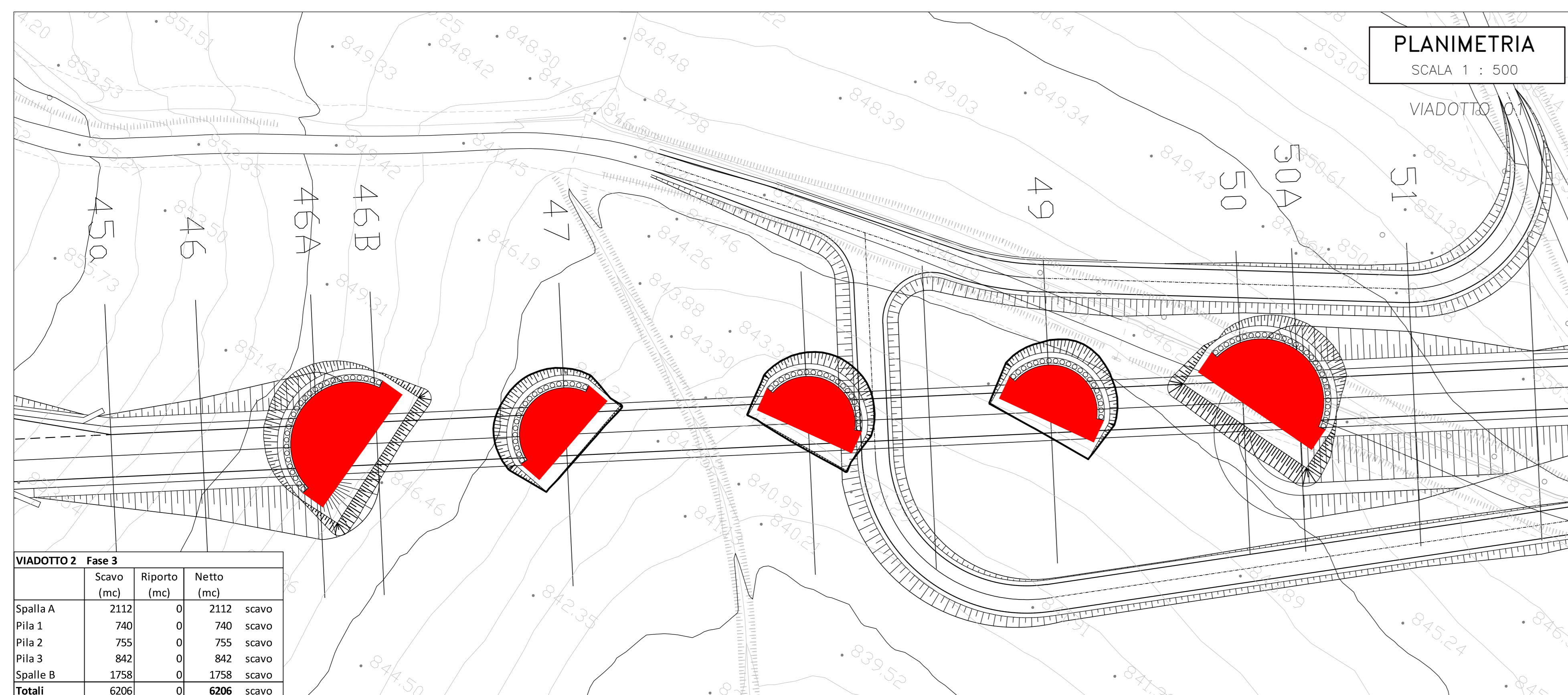
Fase 3: approfondimento scavo per realizzazione tiranti
