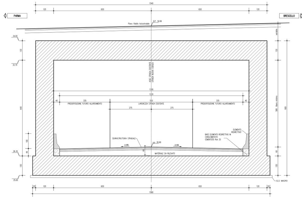
SEZIONE TRASVERSALE SUL MURO DI IMBOCCO AD "U" 1:50
