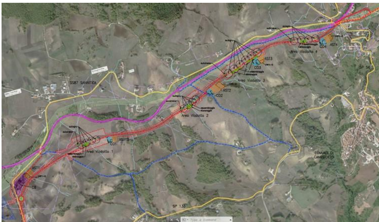
Figura 3 – Planimetria generale sistema di cantierizzazione
