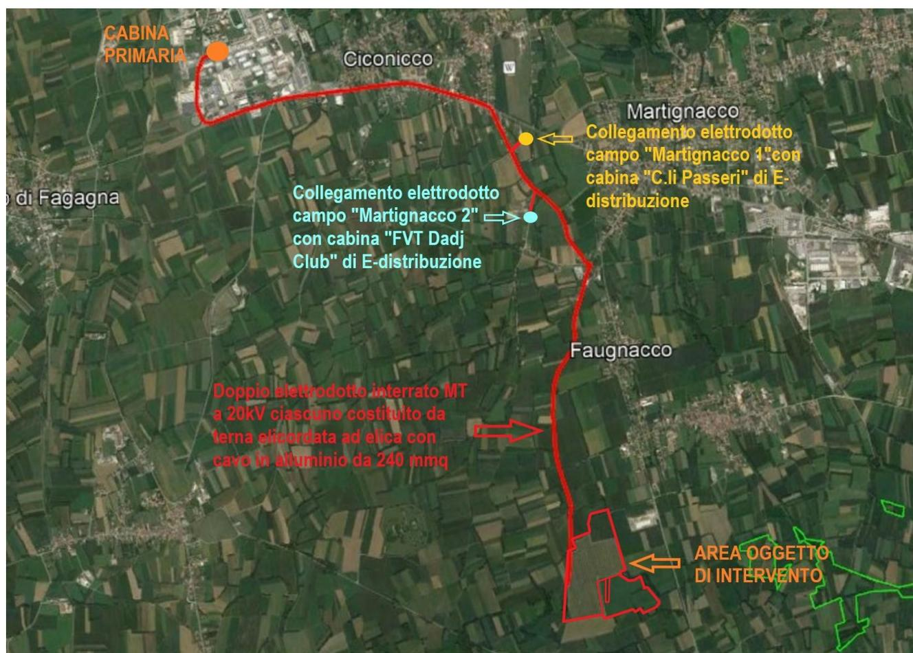
*Vista d'insieme dell'impianto con collegamento elettrodotti interrati MT su base ortofoto*
