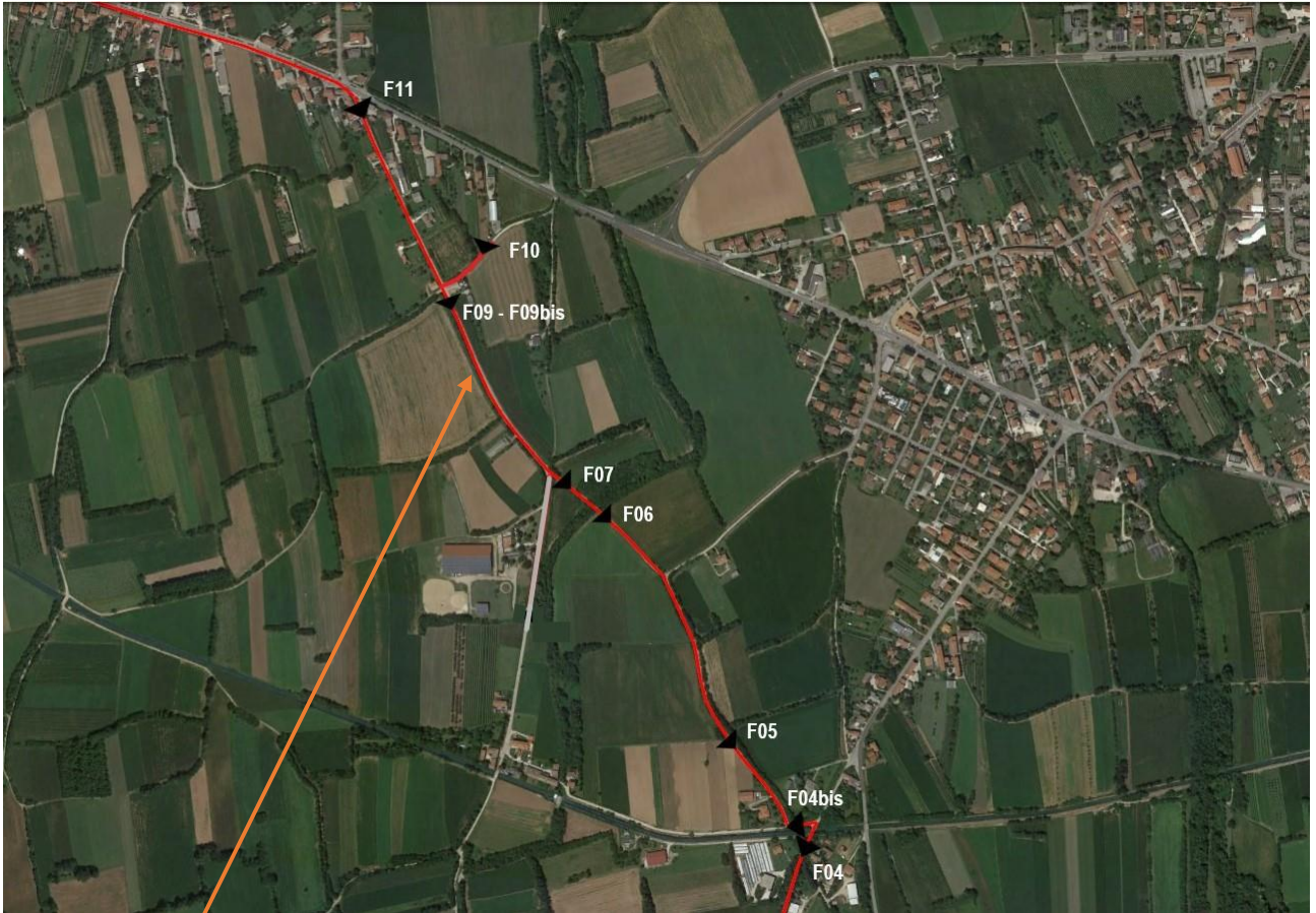
Planimetria d'insieme con cavi MT su base ortofoto – Parte seconda
