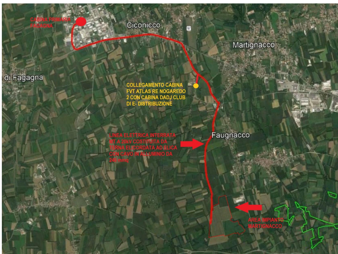
Vista d'insieme dell'impianto con collegamento cavi MT (in rosso) su base ortofoto
