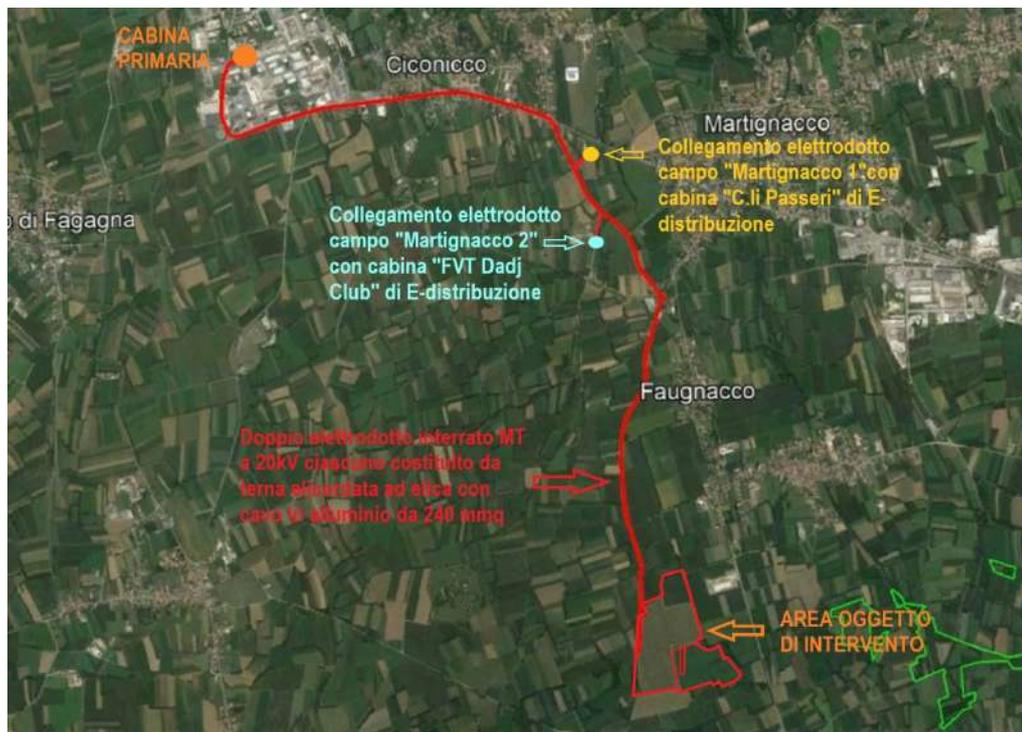
Figure 4-4. Vista d'insieme dell'impianto di connessione con collegamento cavi MT interrati (in rosso) su base ortofoto
